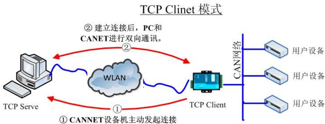
图 4.2 TCP Client 模式通讯示意图
