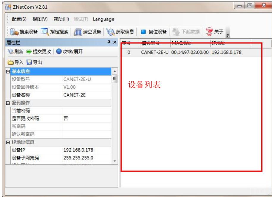
图 5.7 获取 CANET-E(2E)-U 设备配置属性
