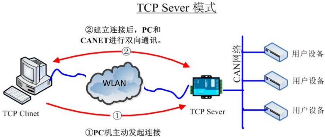
图 4.1 TCP Sever 模式通讯示意图
