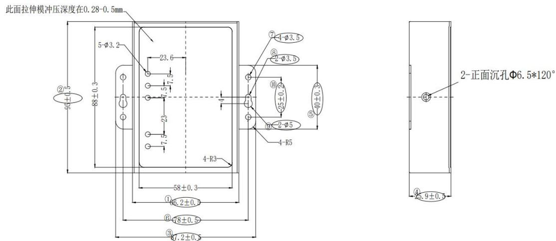
图 1.2 CANET-E(2E)-U 安装机械尺寸
