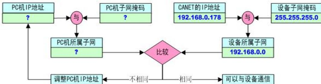
图 3.3 CANET-E(2E)-U 设备 IP 与 PC 机是否处于同一网段检查流程
