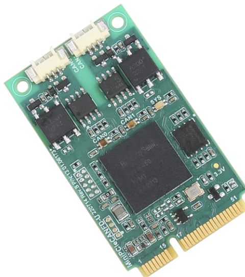
图 1.1 MiniPCleCANFD-U 产品外观
