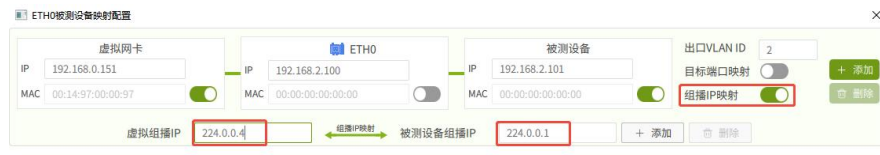
图 4.20 组播 IP 映射配置
