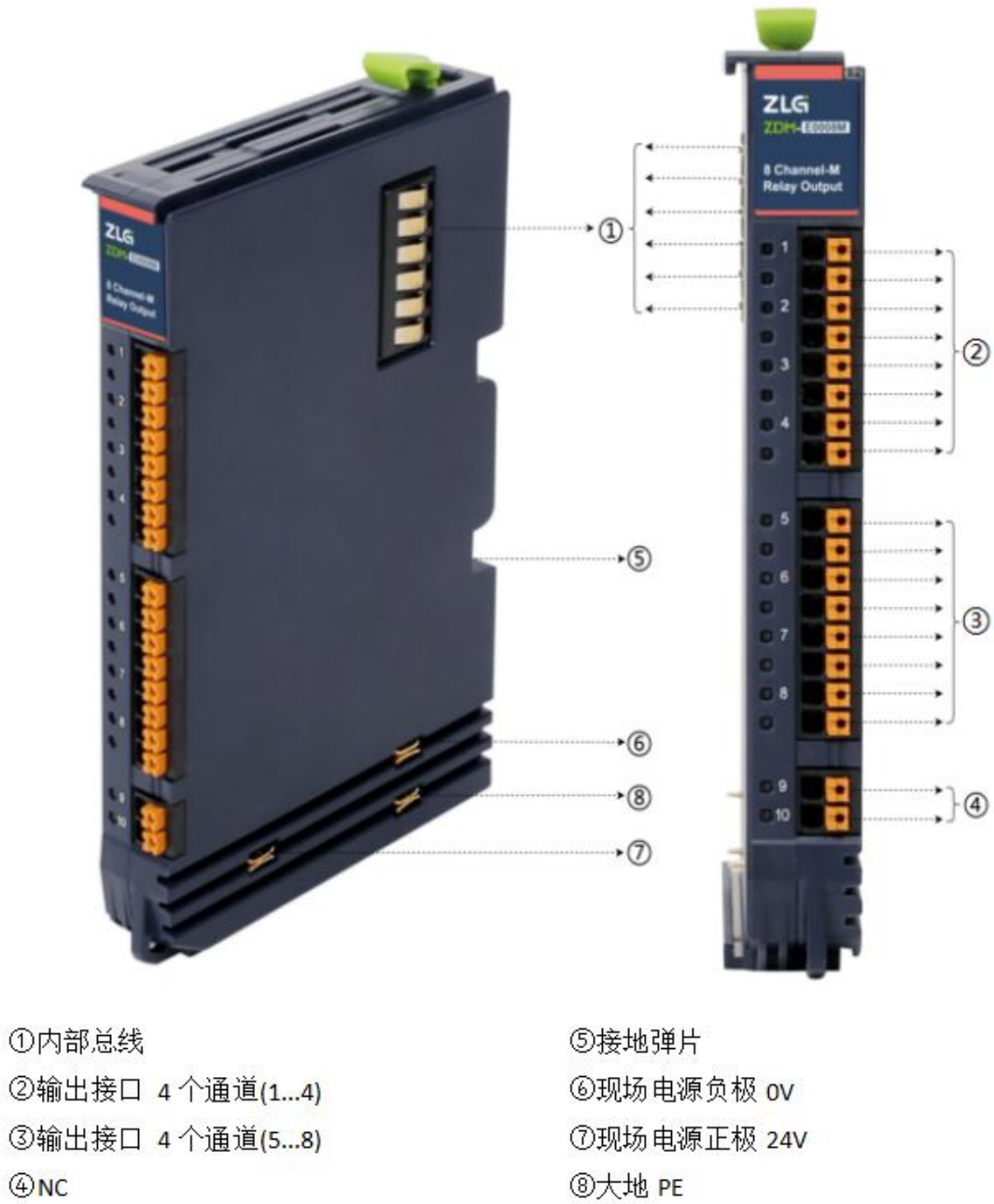
图 2 ZDM-E0008M 引脚定义图
