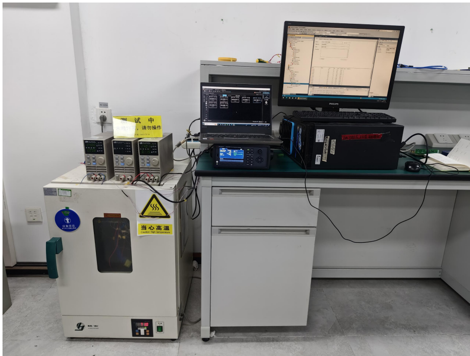
图 6 样机环境试验
