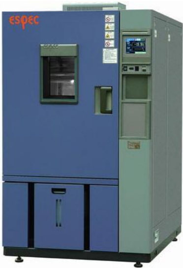
图 1 EK 系列高低温交变湿热试验箱
