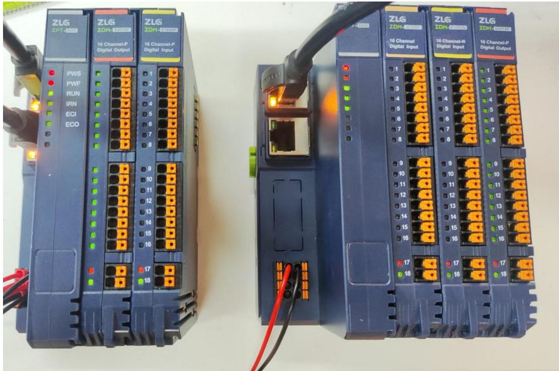
图 5.15 ZPT-8080 功能测试实物接线
