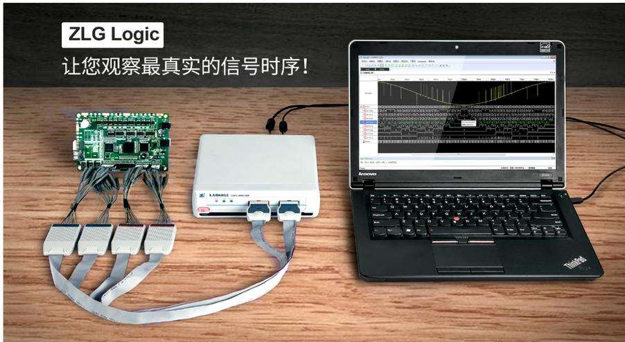
逻辑分析仪是一种类似于示波器的波形分析设备，能够连续不断地采集电路的逻辑电平，并通过存储和波形显示直观地呈现信号时序关系，帮助用户快速调试电路中存在的通信问题。
