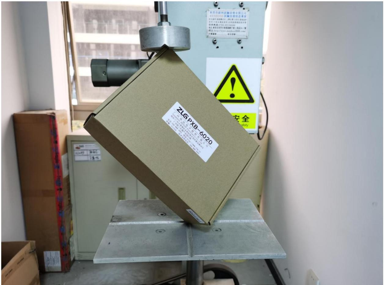
图 24 跌落试验现场图 9
