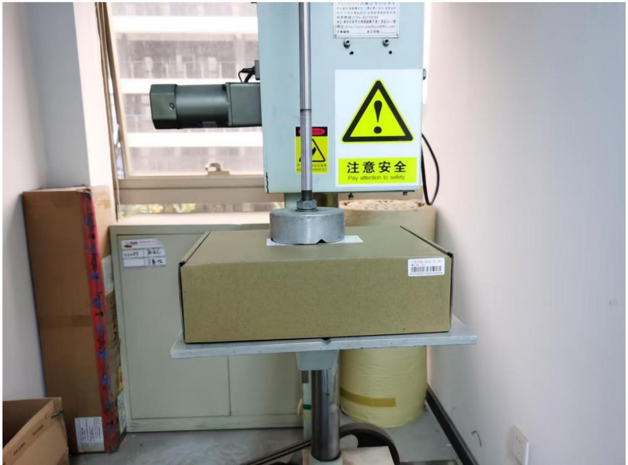
图 25 跌落试验现场图 10
