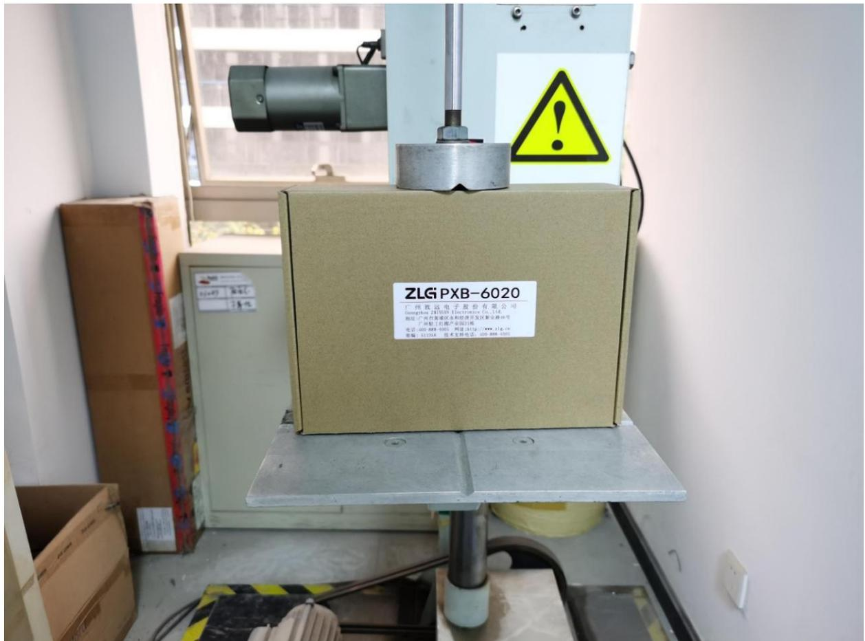
图 16 跌落试验现场图 1
