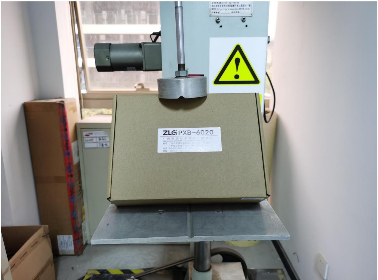
图 23 跌落试验现场图 8
