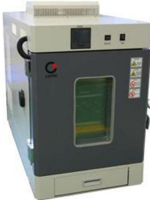
图 2 CEEC-M64H-65 桌面型高低温湿热试验箱
