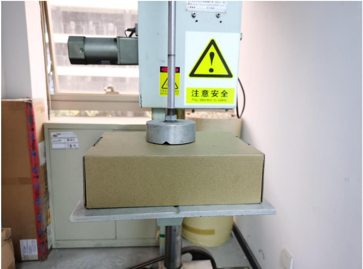
图 17 跌落试验现场图 2
