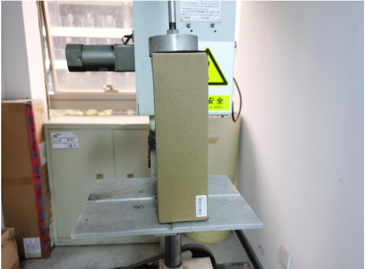
图 20 跌落试验现场图 5
