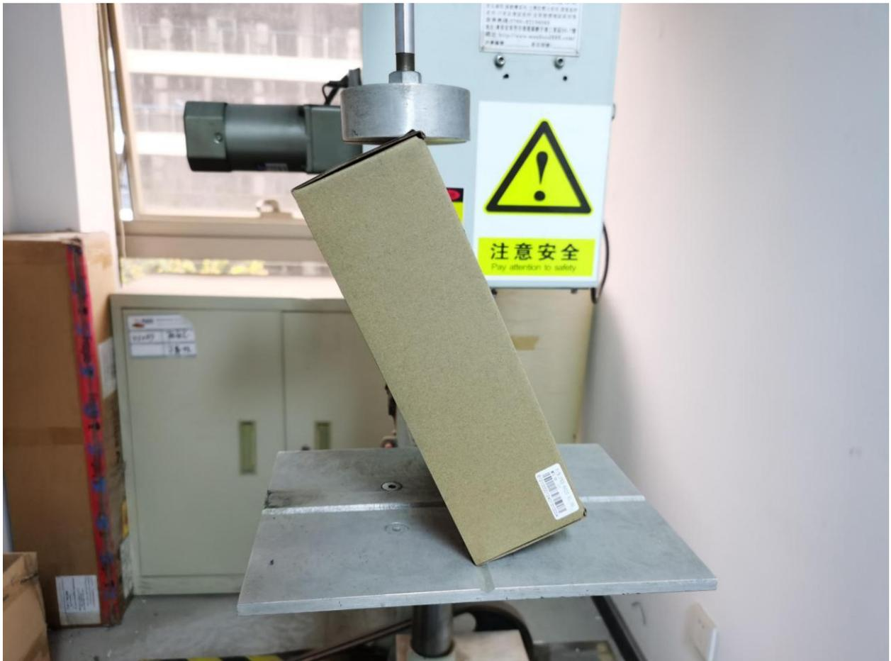
图 21 跌落试验现场图 6
