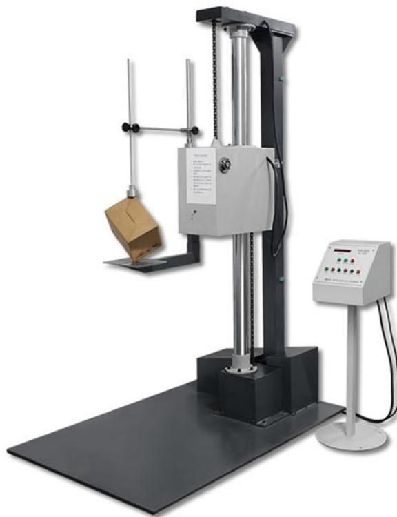
图 4 MH-225 单翼跌落试验机
