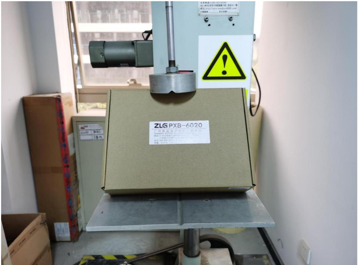
图 22 跌落试验现场图 7
