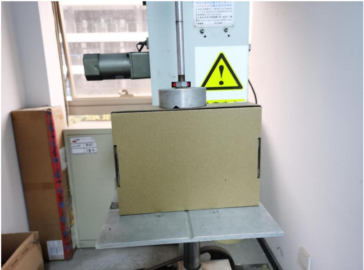
图 18 跌落试验现场图 3
