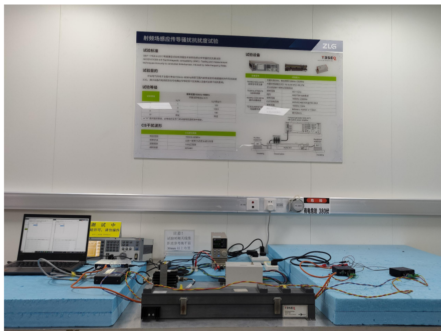
图 12 CS 试验配置
