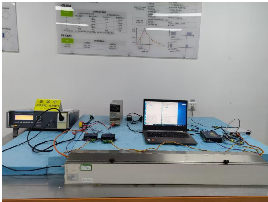
图 10 EFT/B 试验配置
