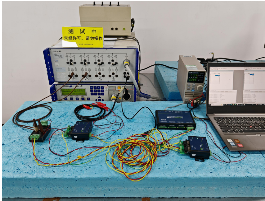
图 14 浪涌试验现场配置图
