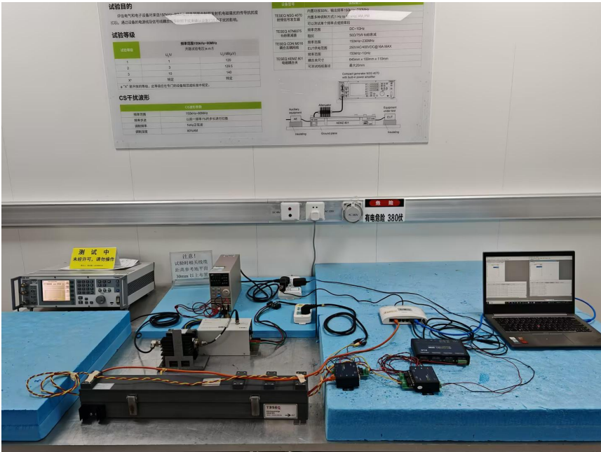
图 13 试验配置②的 CS 试验现场配置图
