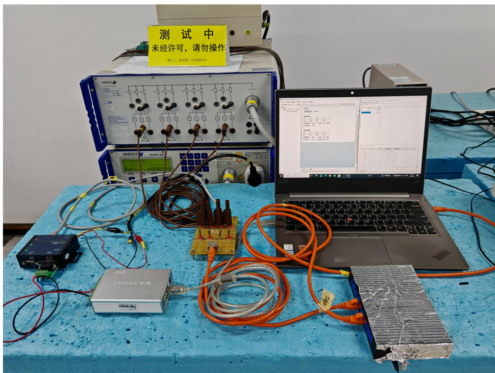
图 9 试验配置②浪涌试验现场图
