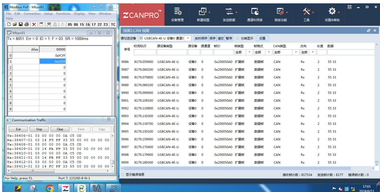
图 20 样机在湿热试验时第一次启动运行检查功能正常 (RTU 模式, 供电电压 9VDC)
