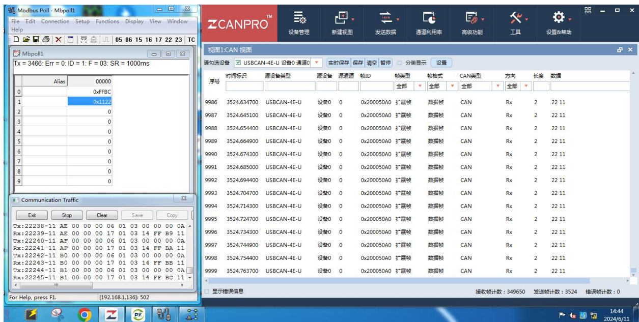
图 19 样机在高温试验时第六次启动运行检查功能正常 (TCP 模式, 供电电压 9VDC)
