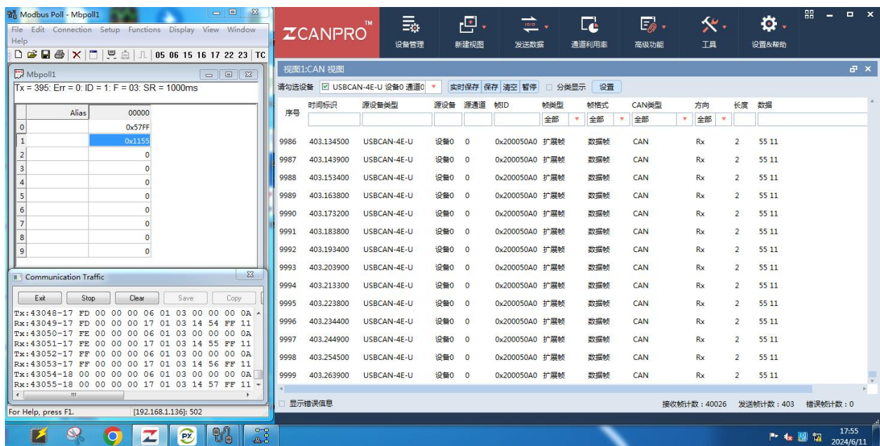
图 25 样机在湿热试验时第六次启动运行检查功能正常（TCP 模式，供电电压 9VDC）
