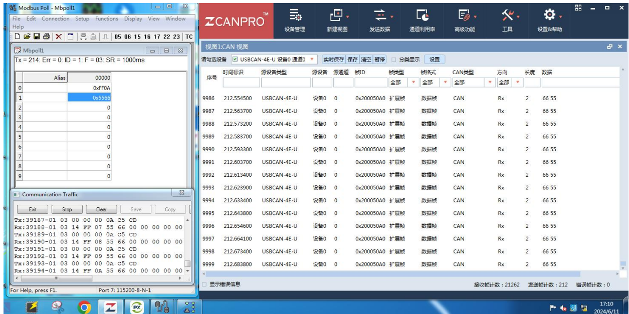
图 21 样机在湿热试验时第二次启动运行检查功能正常 (RTU 模式, 供电电压 12VDC)
