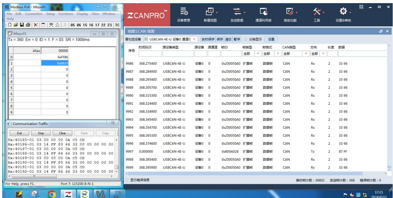
图 22 样机在湿热试验时第三次启动运行检查功能正常 (RTU 模式, 供电电压 36VDC)
