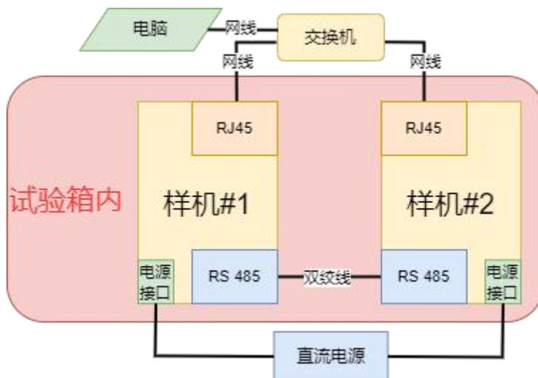
图 2 试验配置框图
