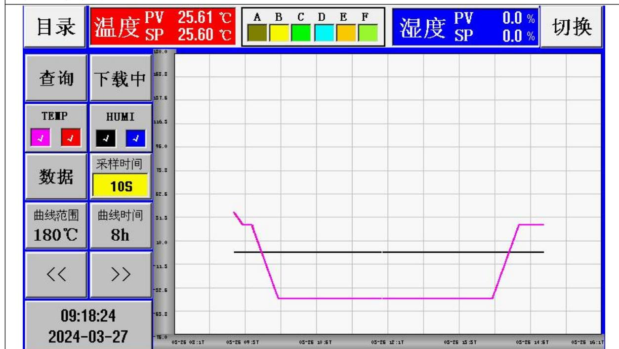
图 6 低温试验曲线
