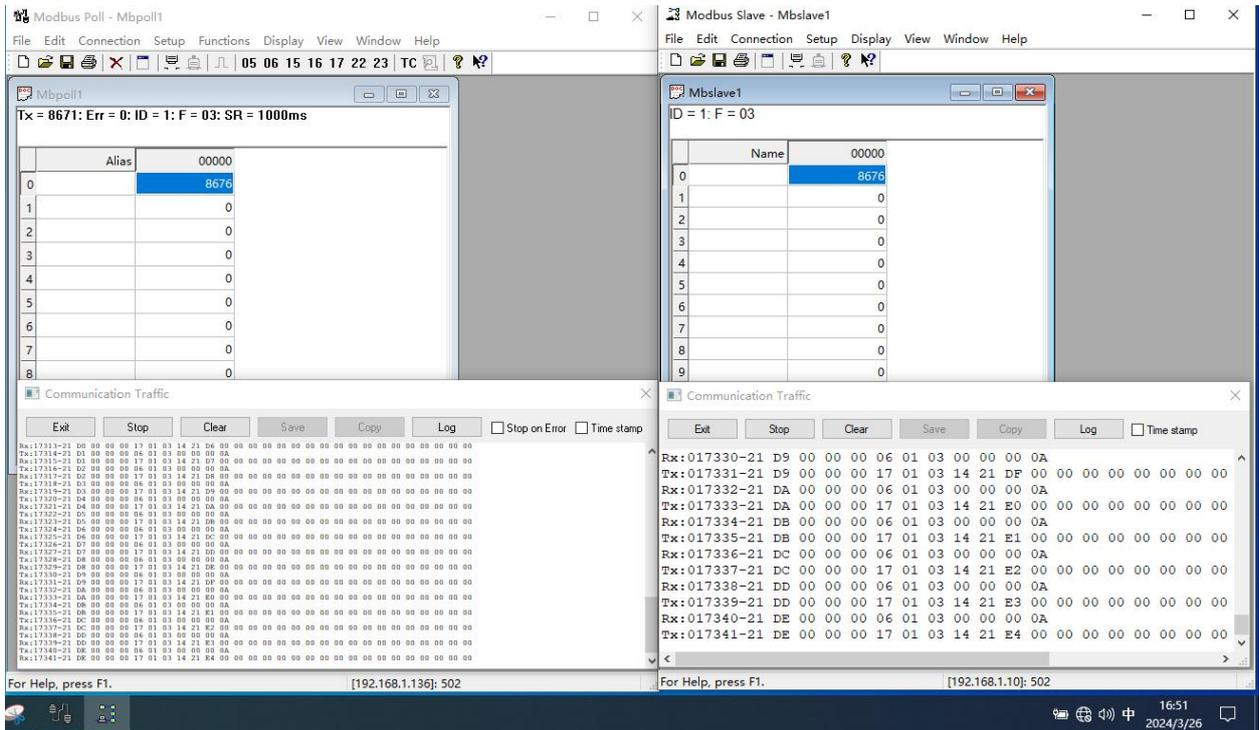
图 17 样机在高温试验时第三次启动运行检查功能正常（供电电压 12VDC）
