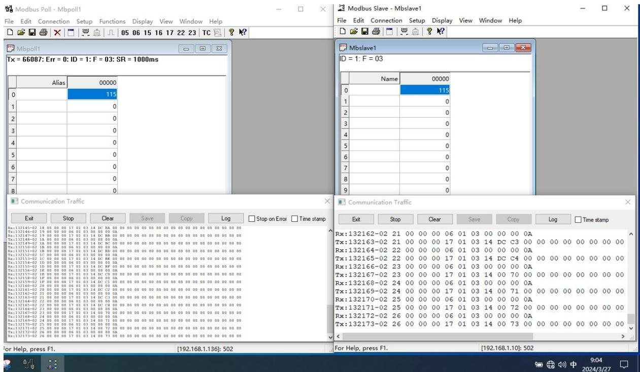
图 18 样机在温度变化试验结束后检查功能测试正常（供电电压 12VDC）
