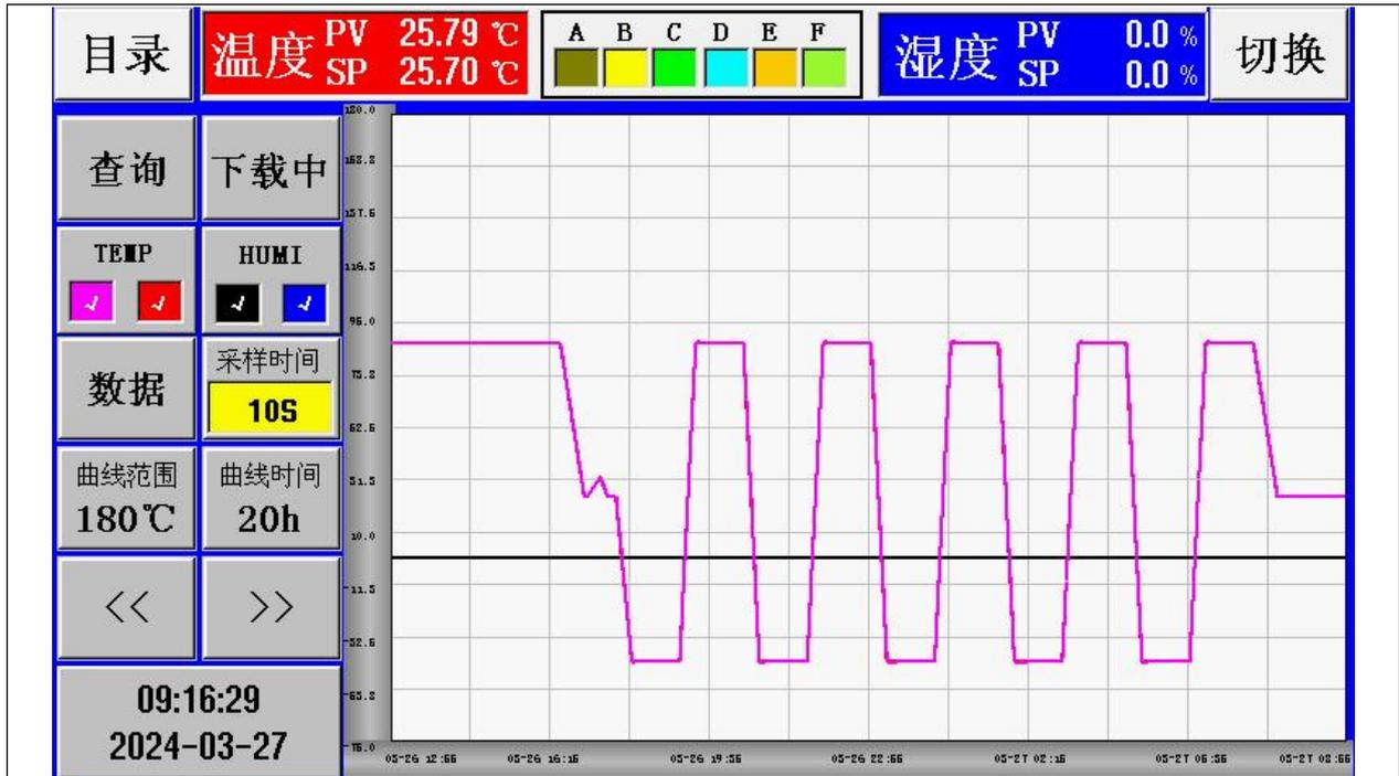
图 8 温度变化试验曲线
