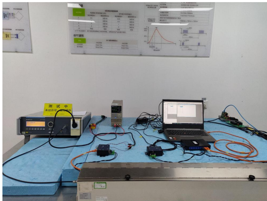
图 6 EFT/B 试验配置
