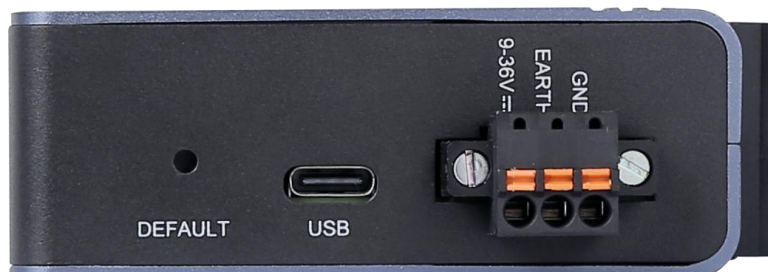
图 2.2 顶部接口定义示意图
