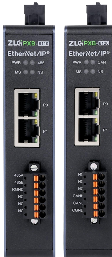
图 2.3 正面接口定义示意图
