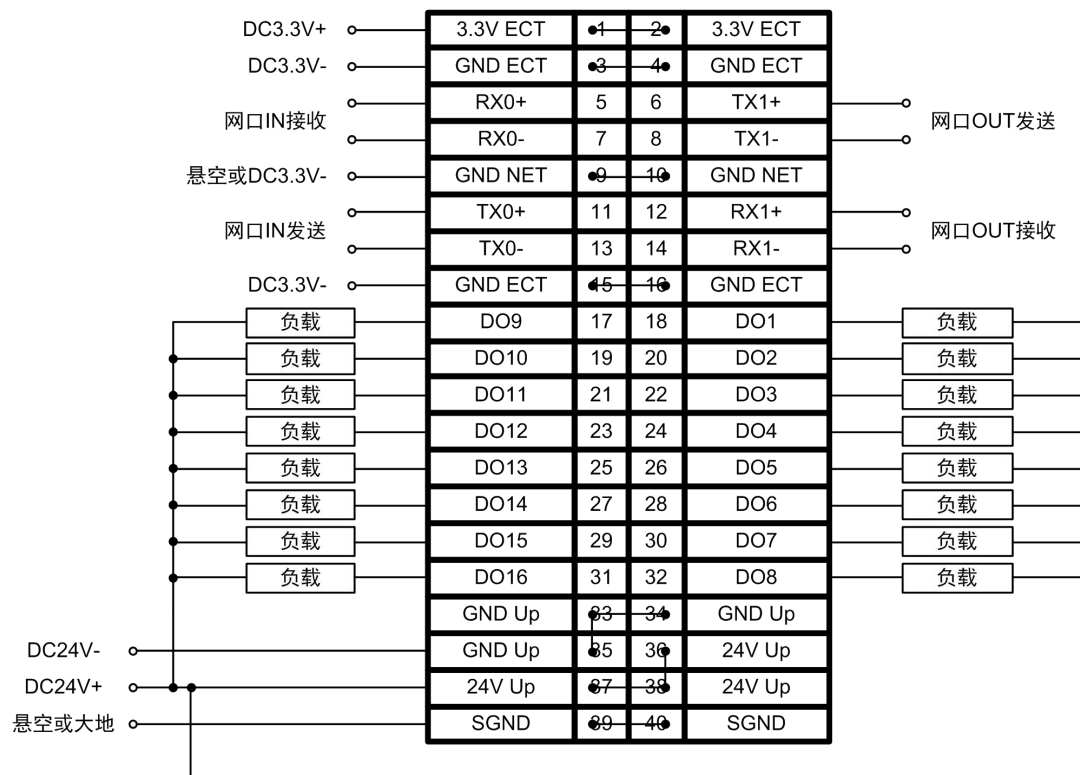
图 4.1 ZIOC-E0016DN 典型接线图
