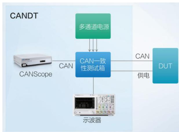
图7 CANDT一致性测试系统架构
