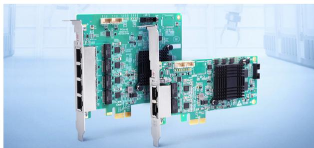
ZLG 致远电子 **PCIe EtherCAT 通讯卡** 是一款高性能的总线控制卡，专为满足高实时的工业控制需求而设计。基于 PCI Express 技术，该卡通过使用实时内核 + 商业授权 EtherCAT 协议栈的方式，实现了高达 125us 的控制周期。
