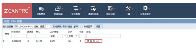
图13 上位机收到EPCM3568A-LI发送的CAN数据帧
