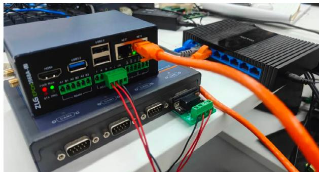
图10 EPCM3568A-LI和USBCAN-8E-U接线
