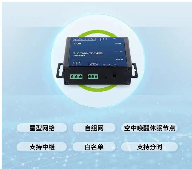
图4 强大的LoRa无线通信功能
