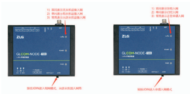
图2 主机（左）和从机（右）的工作状态指示
