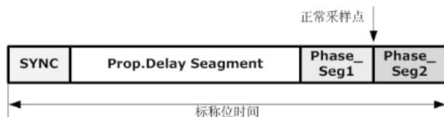
图1 位定时段（位速率和总线长度乘积为最大值）的规格
