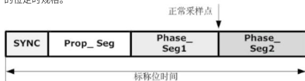
图2 位定时段的规格（适用于最大振荡器误差）
