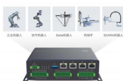
图7 EtherCAT主站控制器系统框图
