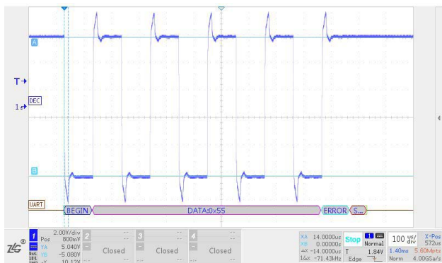
图9 RSM485ECHT 1200m 9600bps 不加终端 末端波形
